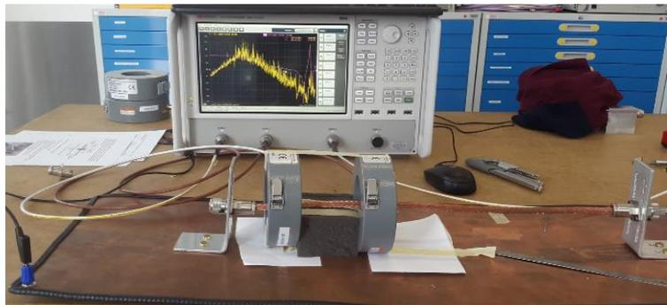
Figure 7 Configuration du test d'injection localisée
