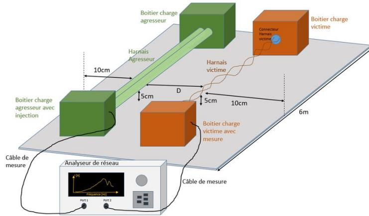
Figure 5 Banc expérimental de mesure de diaphonie
