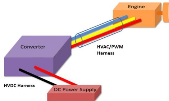
Figure 2 Principe d'une chaîne de puissance HV
