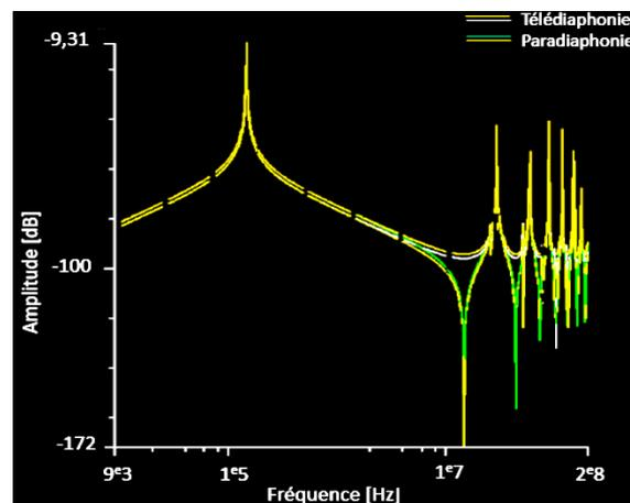
Figure 6 Résultats préliminaires du courant sur la liaison victime en télé et para diaphonie
