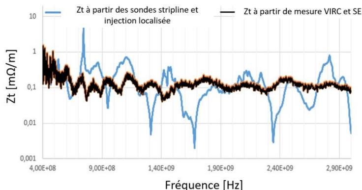
Figure 8 Comparaison du  $Z_t$  obtenu par la SE en VIRC et la valeur obtenue avec les sondes stripline en méthode d'injection localisée
