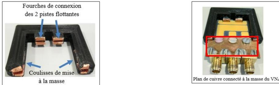
Figure 4 : Interface de mise à la masse des pistes non connectées - seule (a) et en condition de mesure (b).
